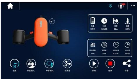
1. Les fonctions de contrôle de l'appareil comprennent : Changement de vitesse : contrôle à distance de la vitesse (doit rester connecté sans fil).
